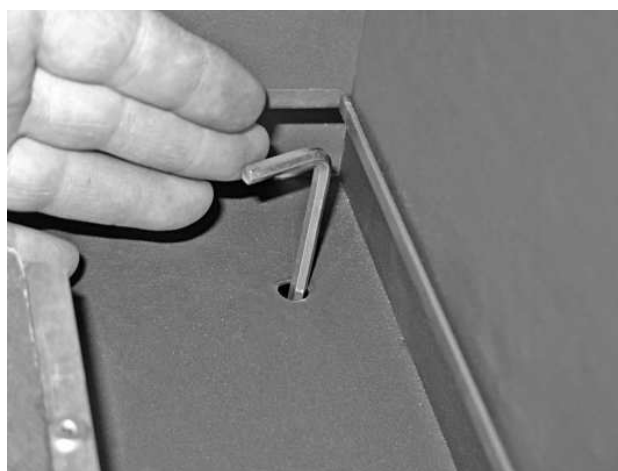
- Einstellung der Höhe mit Sechskant schlüssel Nr. 5.
