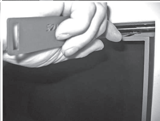
- En utilisant le crochet, retirer les bandes de ressort de métal à la gauche et à la droite des montants du cadrage.
