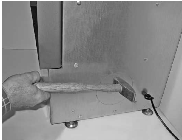
Uitslaan van een opening aan de zijkant
