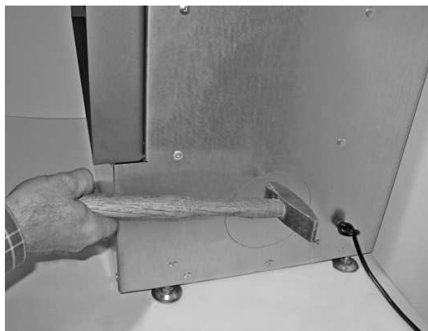
Herausschlagen eines Ausbruchteils an der Seite
