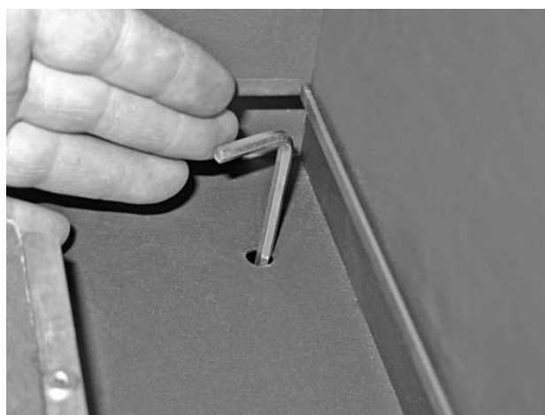
- Einstellung der Höhe mit Sechskant schlüssel Nr. 5.
