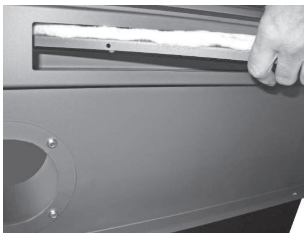
Controle pakking overdrukluik. Het eventueel vervangen van de pakking is mogelijk door het luik op te tillen, te kantelen en via de opening uit te nemen.
