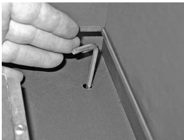
- Ajuste de la altura con la llave Allen n° 5.
